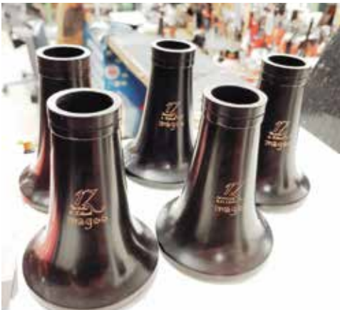
Die magoo-Becher für die neue RZ-Klarinette. Das besondere am Becher ist, dass er ganz aus Holz gefertigt wird.
